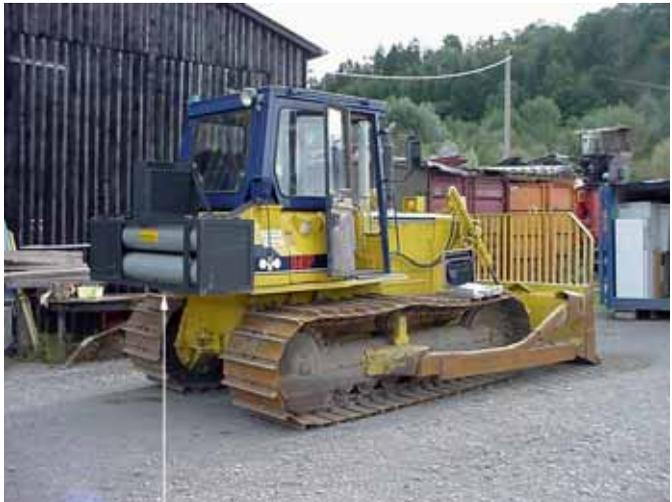
**Raupe mit einer Druckluftanlage; Druckgasflaschen liegend;
