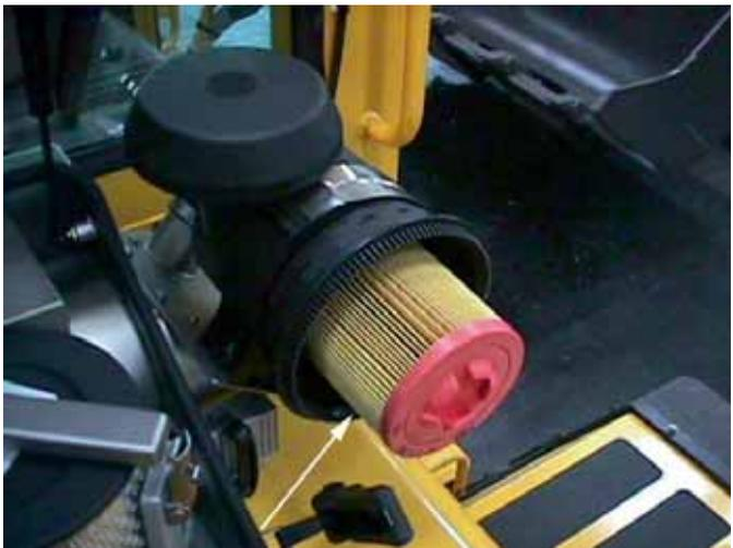
**Filter in Filteranlage (geöffnet) zur Atemluftversorgung**
