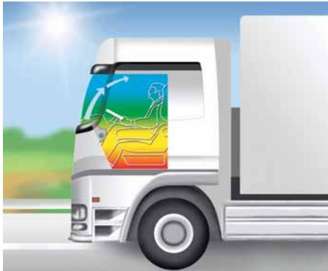
**Luftführung und Temperaturverteilung im Kühlbetrieb**
