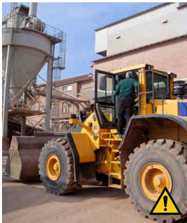
Abb. 3 Achtung Lebensgefahr! Mitfahren auf einem Radlader ist verboten
