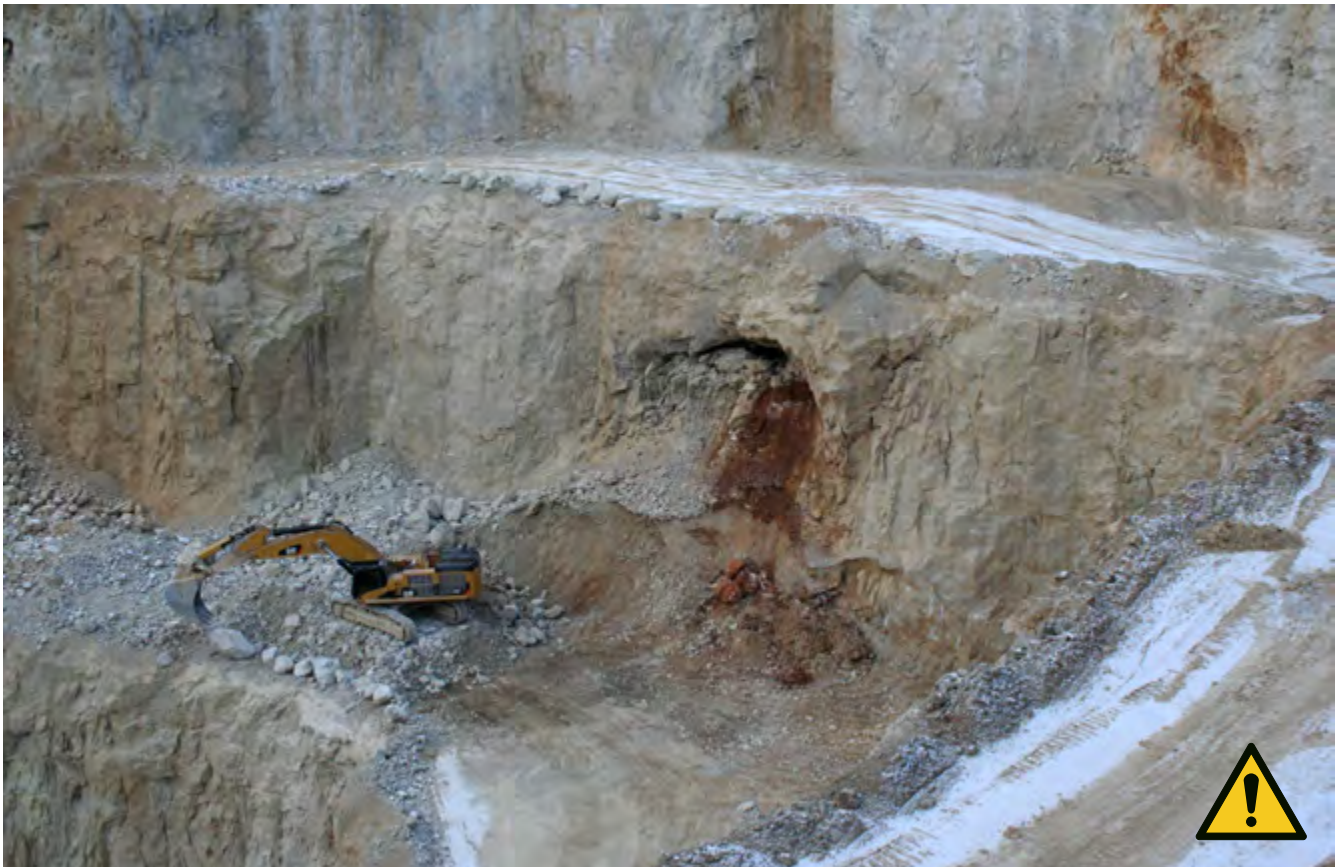
Abb. 1 Unterhöhlungen und Überhänge bedeuten Lebensgefahr
