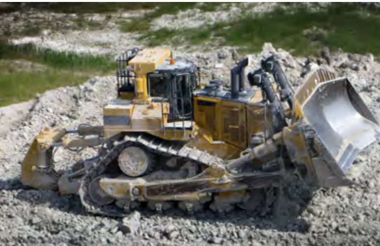
Abb. 2 Gewinnung durch Aufreißen des Gesteins mit einer Raupe
