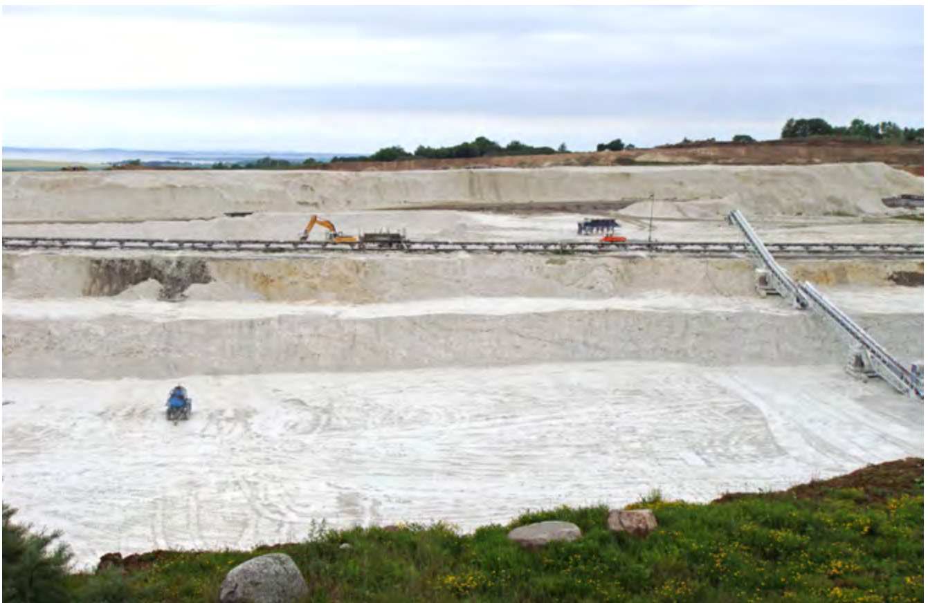
Abb. 1 Ton-/Lehmabbau mit Förderband
