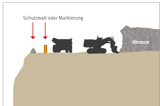
Abb. 4 Schutzstreifen bei maschineller Abraubeseitigung im Hochschnitt
