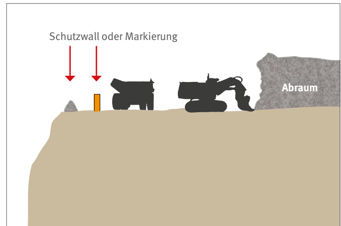
Abb. 3 Schutzstreifen bei maschineller Abraumbeseitigung im Hochschnitt
