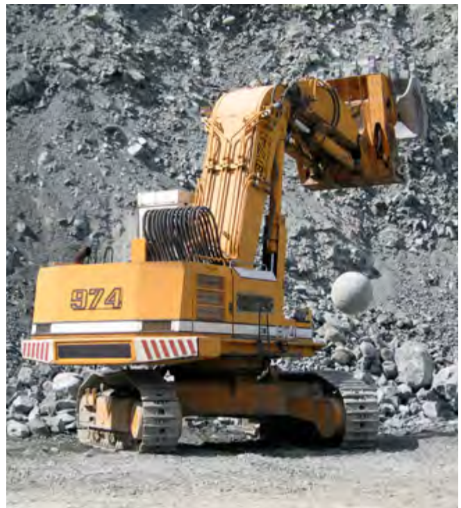
Abb. 3 Nachzerkleinern von Knäppern mit einer Stahlkugel
