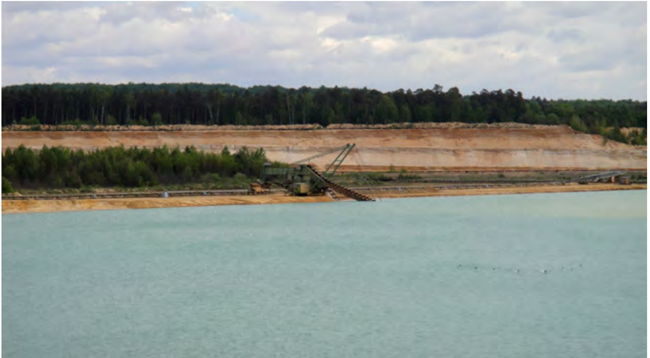
Abb. 1 Nassgewinnung mit Eimerkettenbaggern im Betrieb
