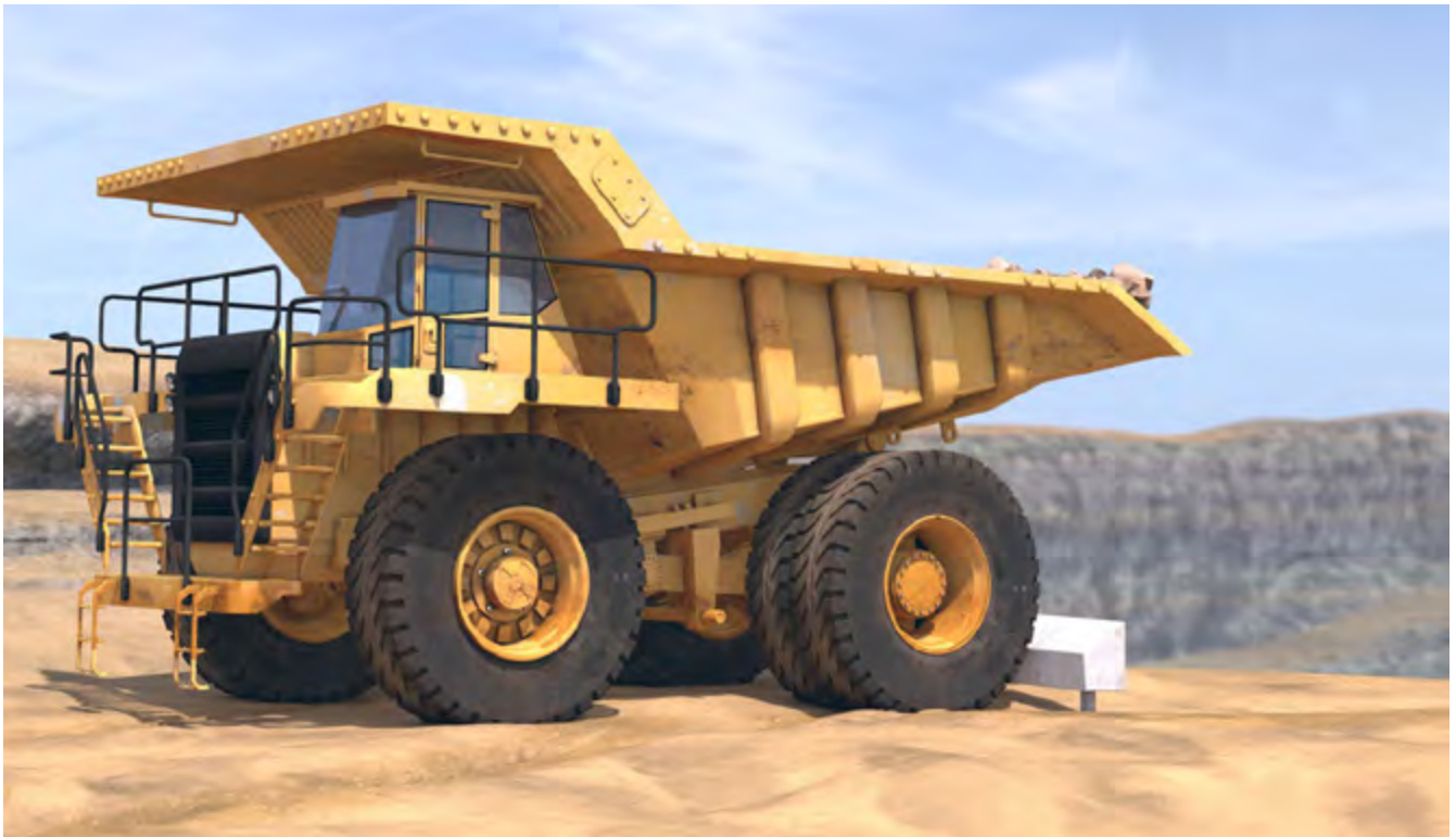
Abb. 1 Regelgerechte Ausführung einer Abkippstelle
