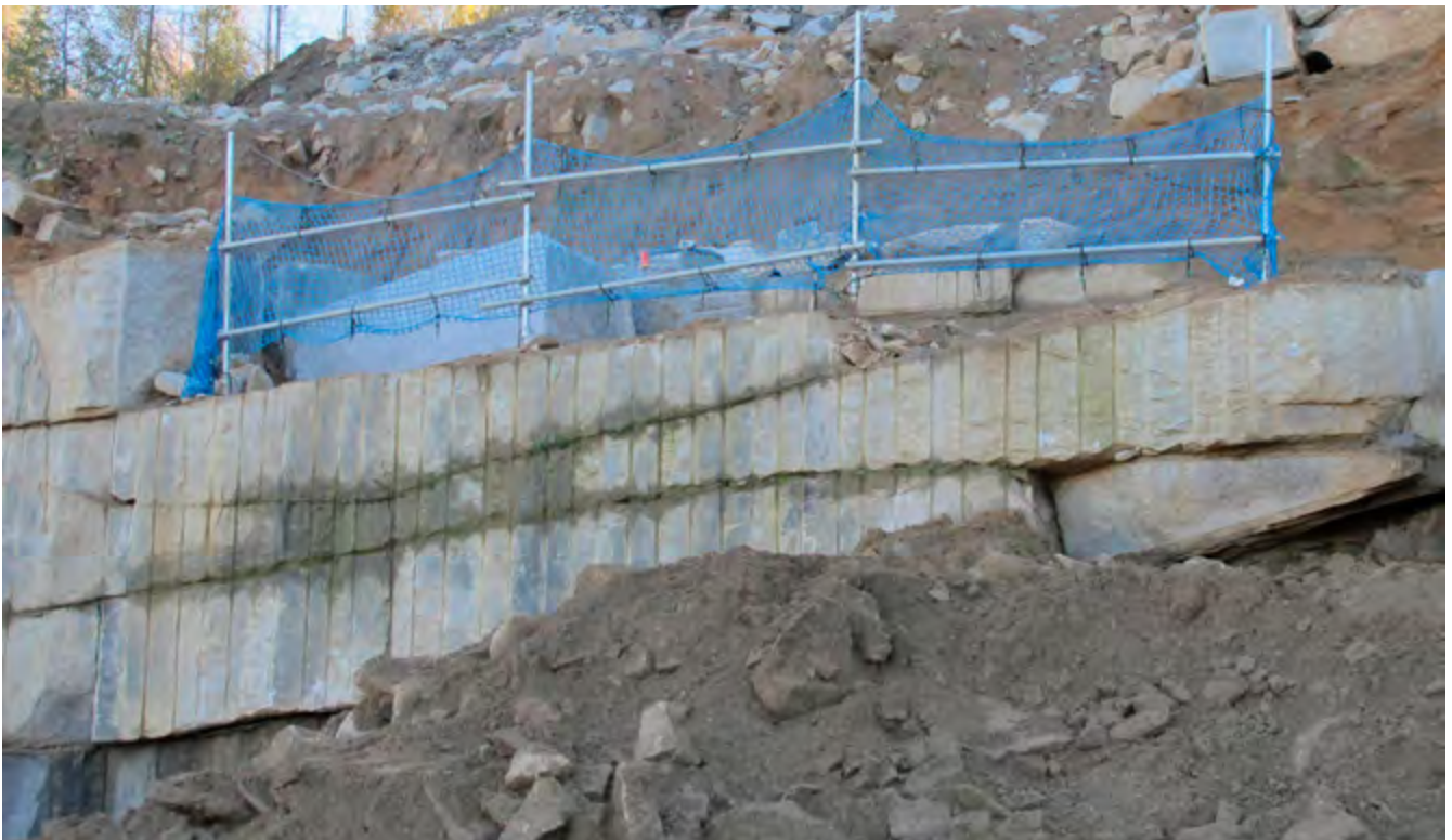
Abb. 1 Absturzsicherung an einer Wand im Werksteinbruch
