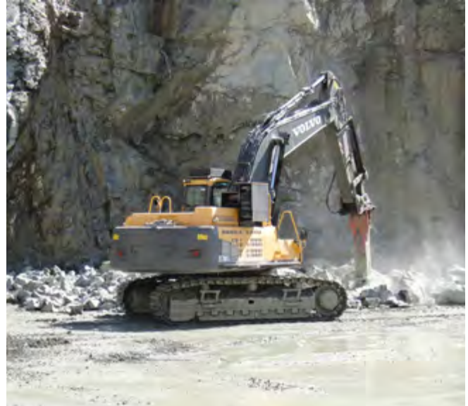
Abb. 2 Nachzerkleinerung mit einem Hydraulikhammer
