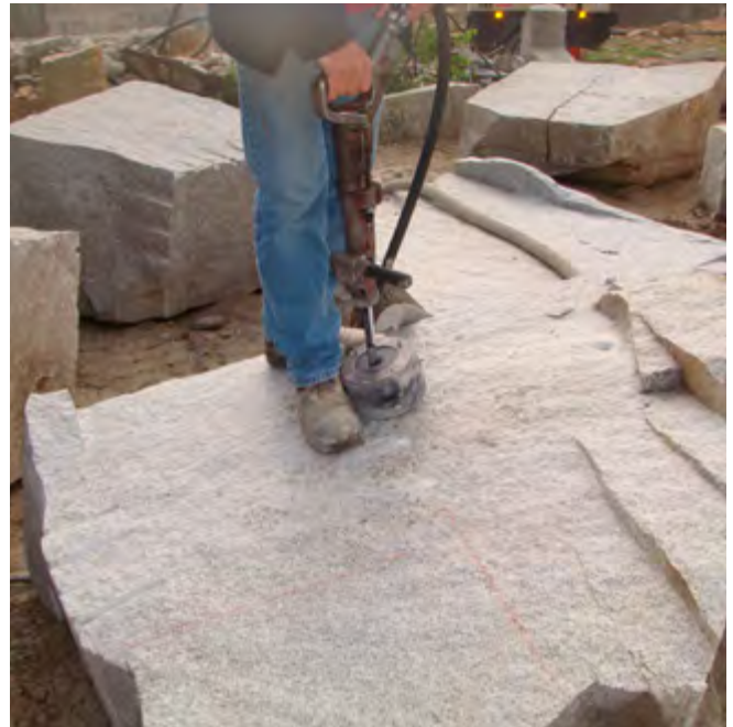
Abb. 2 Arbeiten auf dem Rohblock mit Absaugung
