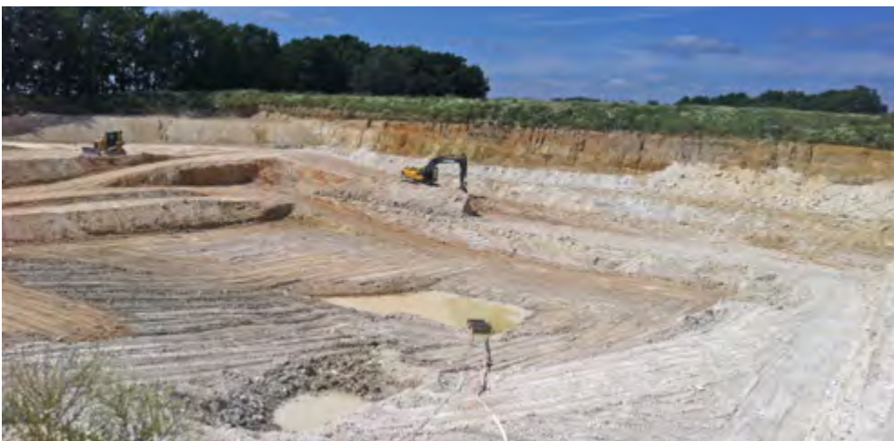
Abb. 2 Lagenweise Gewinnung in Tongrube
