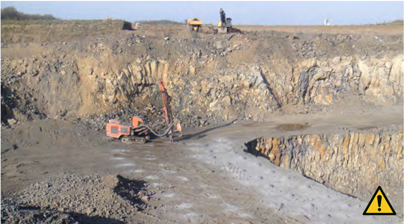
Abb. 1 Großbohrlochmaschine arbeitet senkrecht zur Bruchwand. Achtung: Absturzgefahr an der Bruchkante.
