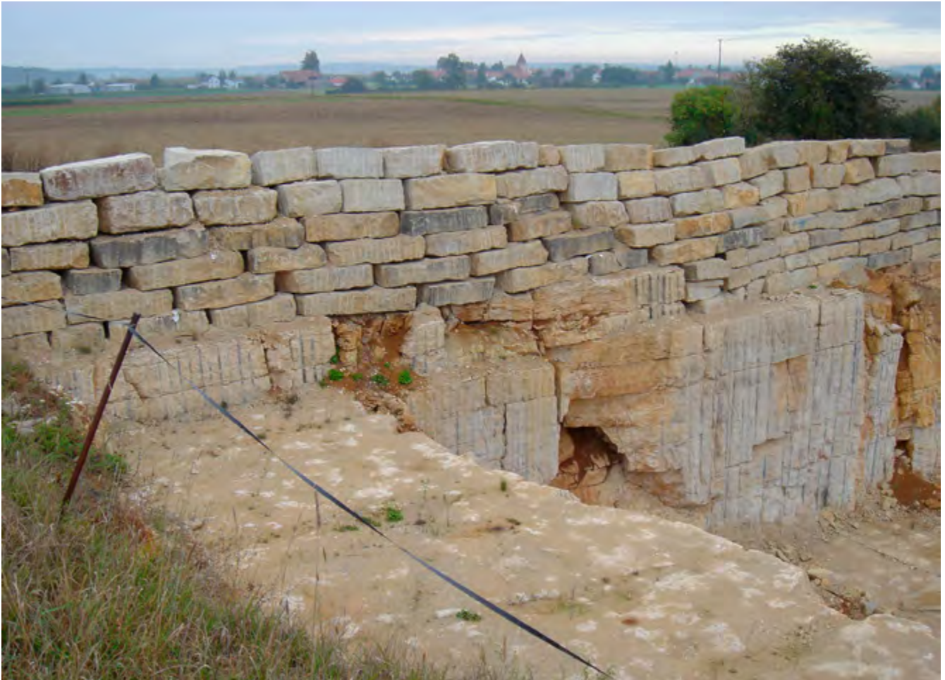
Abb. 1 Abraum ausreichend beseitigt – Schutzstreifen ausreichend
