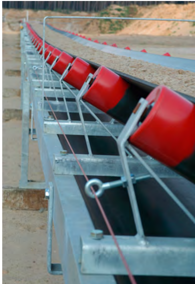
Abb. 3 Förderband mit Reißleine für den Not-Halt
