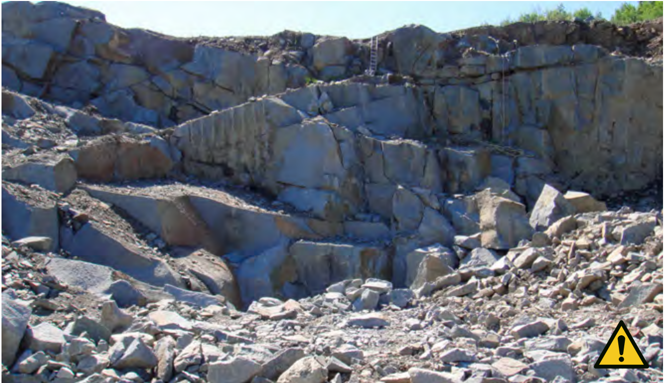
Abb. 1 Unregelmäßiger Wandaufbau im Werksteinbruch
