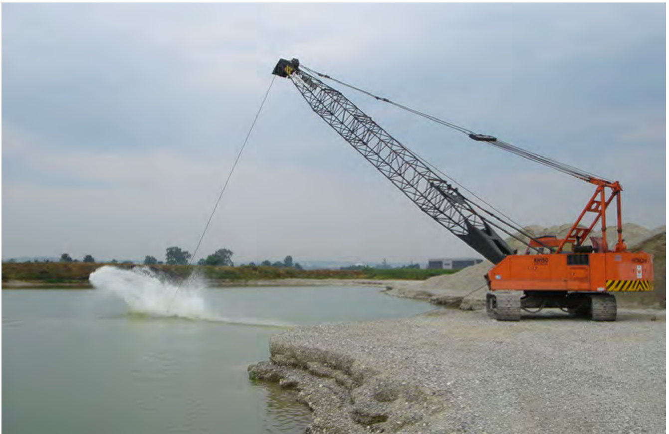
Abb. 1 Bei der Nassgewinnung ist ein ausreichender Abstand zur Uferböschung notwendig
