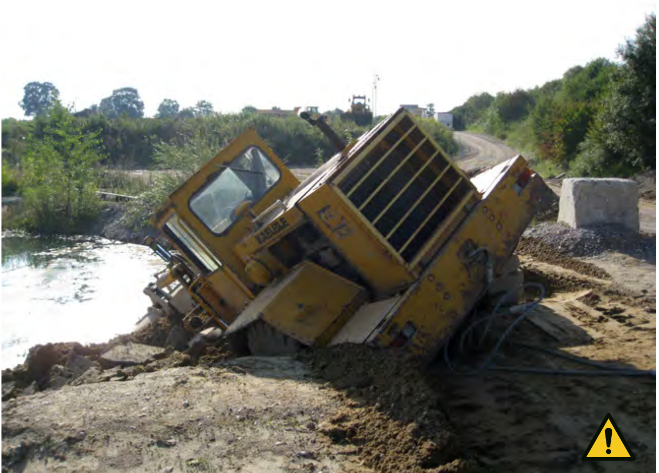
Abb. 2 Einsinken in nicht verfestigten Materialien sedimentiertem Feinstmaterial
