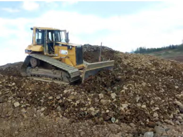
Abb. 1 Raupen im Steinbruch. Die Tür muss beim Fahren geschlossen bleiben
