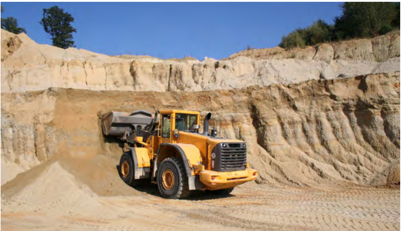
Abb. 2 Gewinnung mit dem Radlader und regelgerechter Wandhöhe
