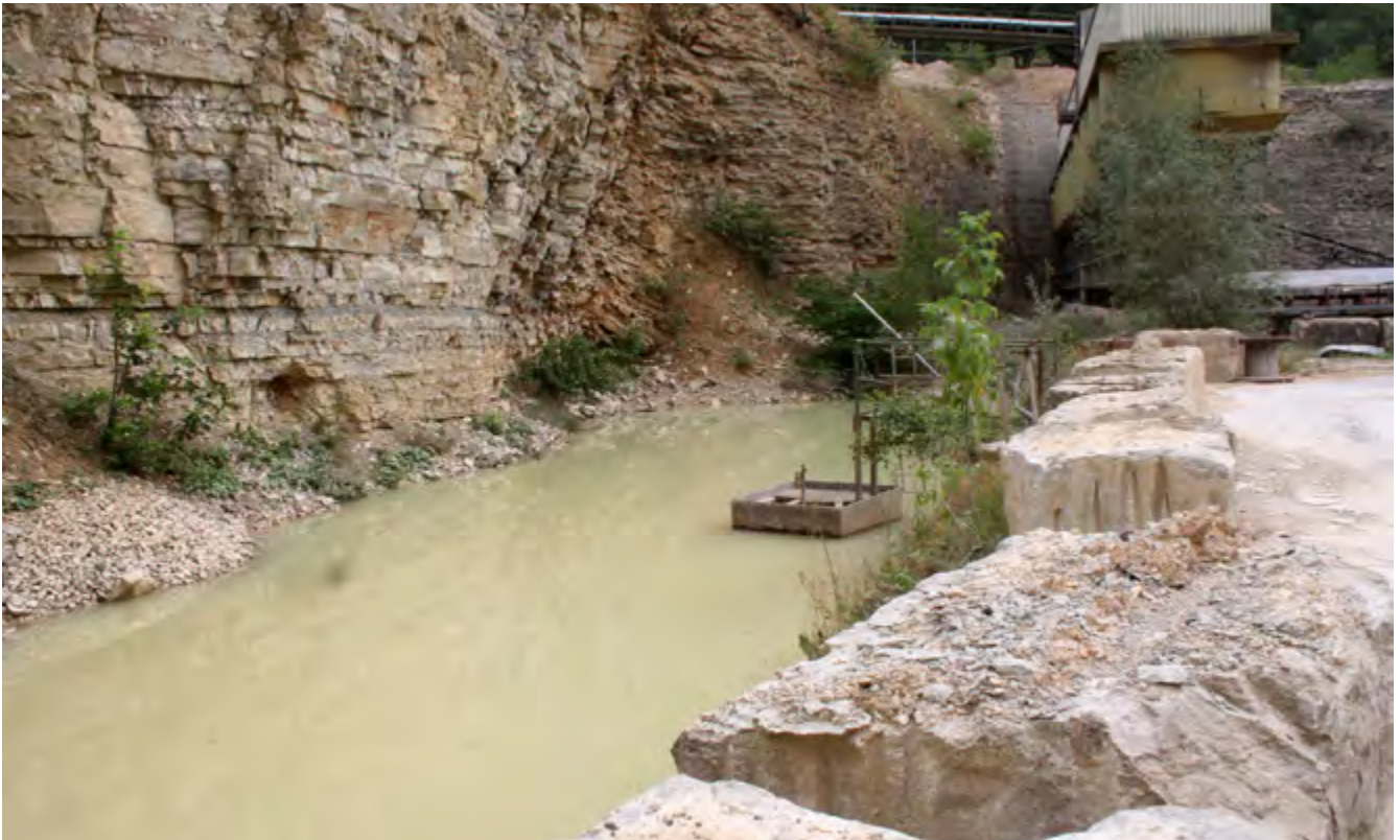
Abb. 1 Absetzbecken mit Rohblöcken als Randsicherung
