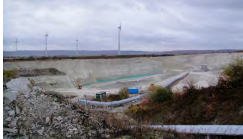
Abb. 2 Abgedecktes Landband zum Schutz vor Witterungseinflüssen
