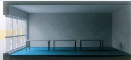
Bei Fenstern, die bis zum Boden reichen, erhöht sich die Beleuchtungsstärke auf der Arbeitsebene (Arbeits-tisch) nicht relevant. Auch hier erhält der Arbeitsplatz in der Raumtiefe wenig Tageslicht. Jedoch sind die Wärmeeinträge im Sommer und die Wärmeverluste im Winter höher.
