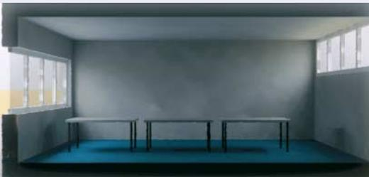
Durch die zusätzlichen hoch liegenden Fenster auf der anderen Raumseite wird die Beleuchtungsstärke in der Raumtiefe deutlich angehoben. Die hoch liegenden Fenster ersetzen aber keine Fenster mit Sichtverbindung nach außen.
