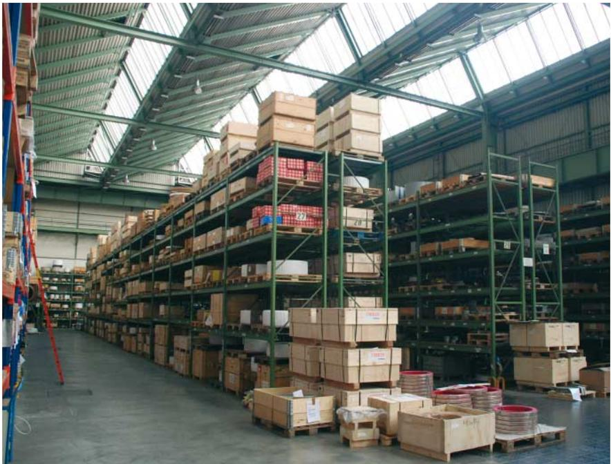
**Bild 11:** Nutzung des Tageslichts in einem Lager durch ein Sheddach.
