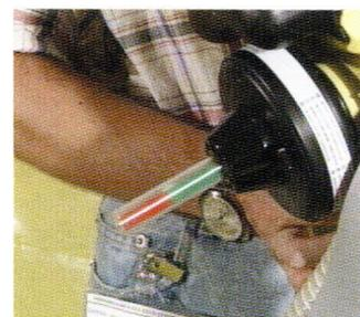
Verifica con flussimetro dell'efficienza del sistema filtrante di un elettro respiratore TMP3
