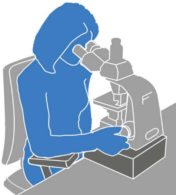
Abb. 15: Arbeitshöhe wurde durch Hilfsmittel (Ellbogenpolster, Unterlage für das Mikroskop) erhöht, um die natürliche Form der Wirbelsäule beizubehalten
