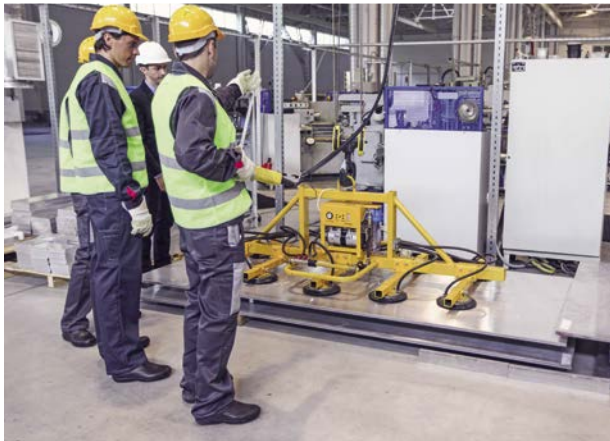
Abb. 5: Hebe- und Transporthilfen als Entlastungsmaßnahme
