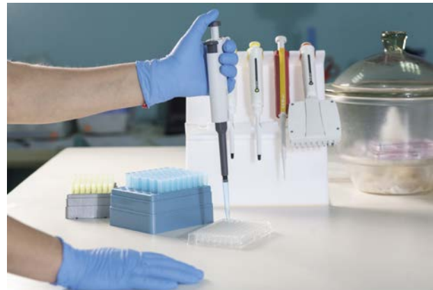
Abb. 3: Moderne, ergonomisch bedienbare Einfach-Pipette (reduziert Überbeanspruchung)
