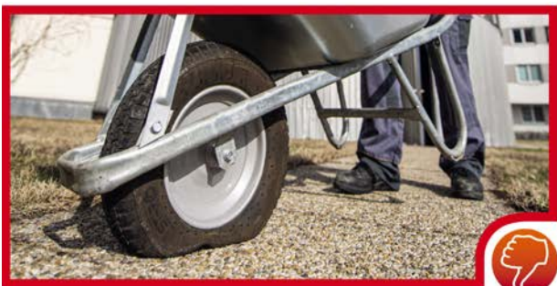
Abb. 6: Erschwertes Schieben mit Reifen ohne ausreichenden Luftdruck
