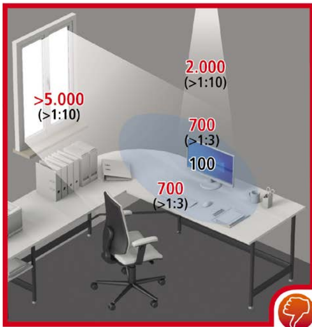
Abb. 27: Helligkeitsunterschiede (Leuchtdichteverteilung) in einem Büro in Candela pro m 2 . Zu starke Helligkeitsunterschiede können durch entsprechende Beschattung oder geeignete Beleuchtung korrigiert werden. Im inneren Gesichtsfeld sollten Flächen ein Leuchtdichteverhältnis von maximal 1:3 aufweisen (z. B. Tisch:Bildschirm), im äußeren Gesichtsfeld ein Verhältnis von maximal 1:10 (z. B. Bildschirm:Fenster).
