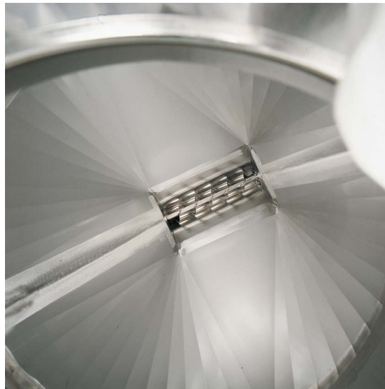
Bild 34: Silokonuss mit waagerechter Räumschnecke (rechts: AZO GmbH & Co. KG)
