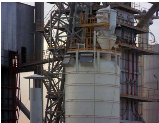
Bild 5: Silobefüllung über Zyklonabscheider (mit seitlicher Explosionsdruckentlastung)
