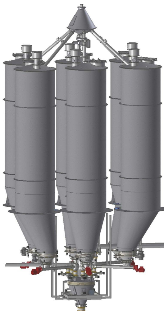
Bild 8: Silobefüllung über Drehrohrverteiler (AZO GmbH & Co. KG)
