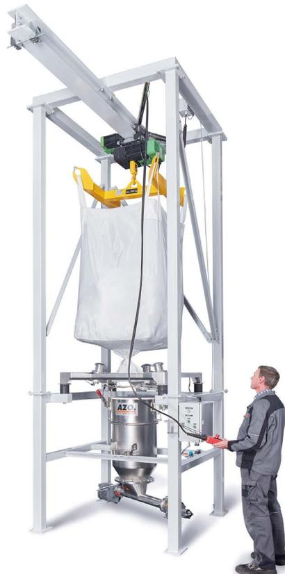
Bild 4: Entleerstation für FIBC's
