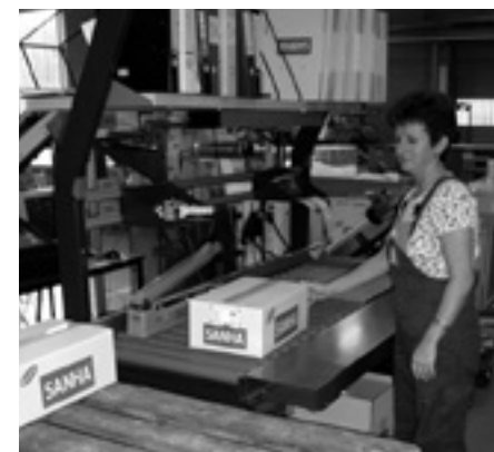
Obrázek 10: Prevence činnosti zvedání a přenášení prostřednictvím výškově nastavitelných pracovních stolů a válečkových dopravníků
