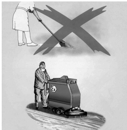
그림3: 분진운을 제거하기 위한 부적절한/적절한 방법
