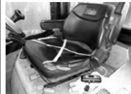
Obr. 2: Měření vibrací celého těla
