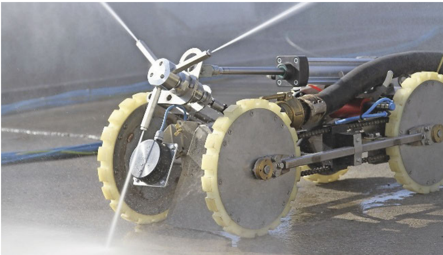
... der T-Rex von HWT Hansen „jagt“ Ablagerungen in Tankinnenräumen.
